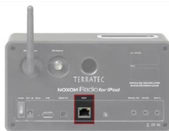
Inoltre, sopra nei pressi della presa si trovano due LED che informano se (**arancione**) c'è un "Link", cioè una connessione corretta con il punto di collegamento della rete ("nodo collegato"), o se c'è "Traffic" e quindi traffico di dati (**verde** e di solito tremolante).
