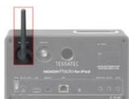
La connessione con un Accesspoint (AP), un router o computer viene stabilita tramite un segnale via radio.
