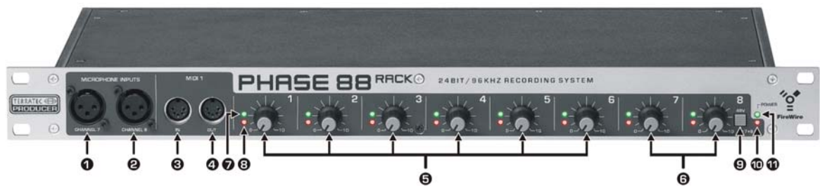
il pannello frontale PHASE 88 Rack FW
