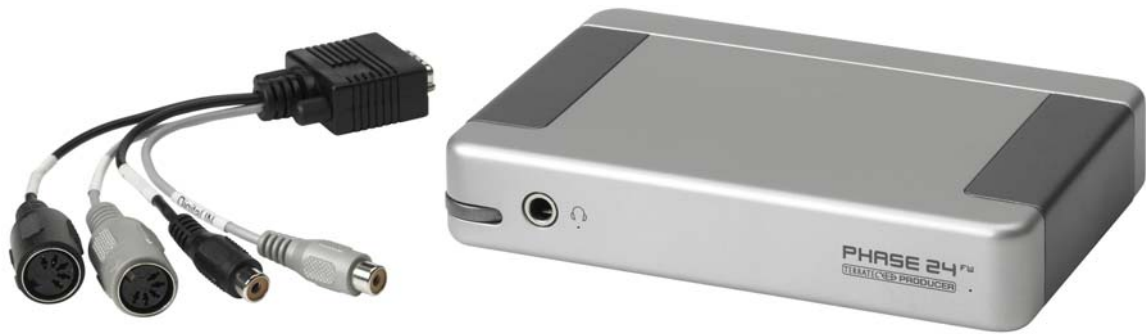
PHASE 24 FW Vorderseite mit Kabelpeitsche
